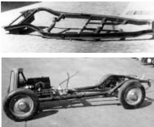
Oben: der erste Versuchsrahmen für den BMW 303. Unten: die neue, leichte Rohrrahmen-Konstruktion für die Serie.
