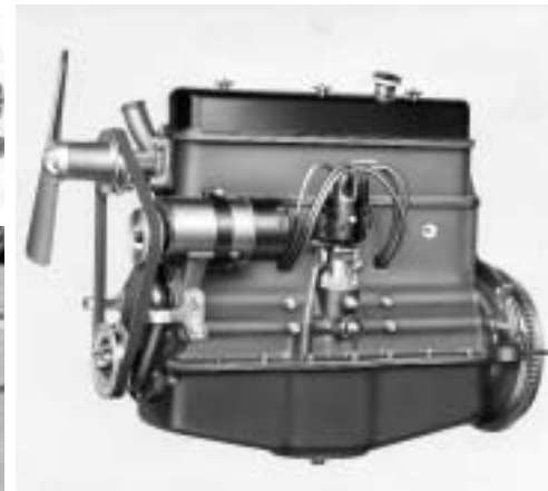
Basis des Erfolgs: der 1,2-Liter-Sechszylindermotor mit 30 PS.
